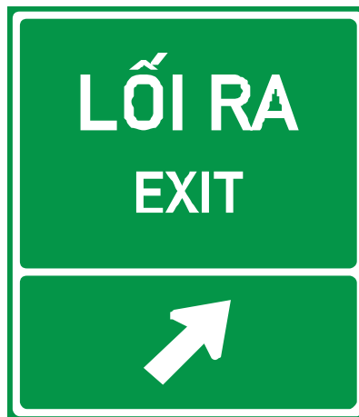
Hình 33 - Biển số IE.474 chỉ dẫn lối ra
