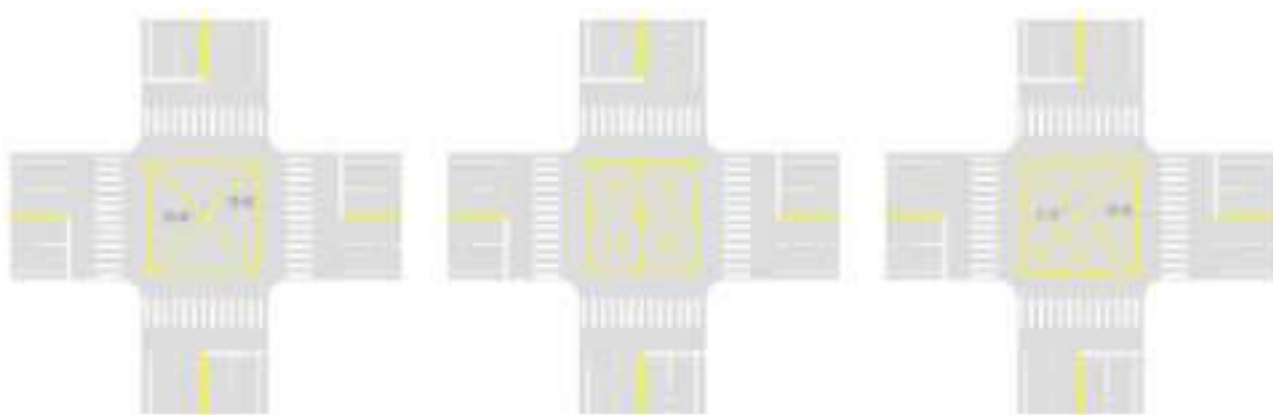
Hình G.38 - Minh họa bố trí vạch kẻ kiểu mắt võng tại nút giao ngã tư
