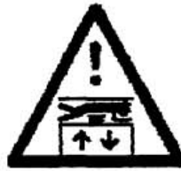
Hình 3 – Dấu hiệu cảnh báo "Nguy hiểm bị ép lên trần giếng thang"
