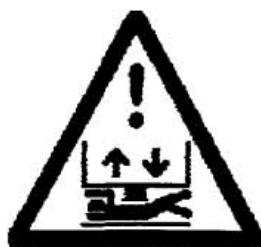
Hình 4 – Dấu hiệu cảnh báo "Nguy hiểm bị ép xuống đáy hố thang"
